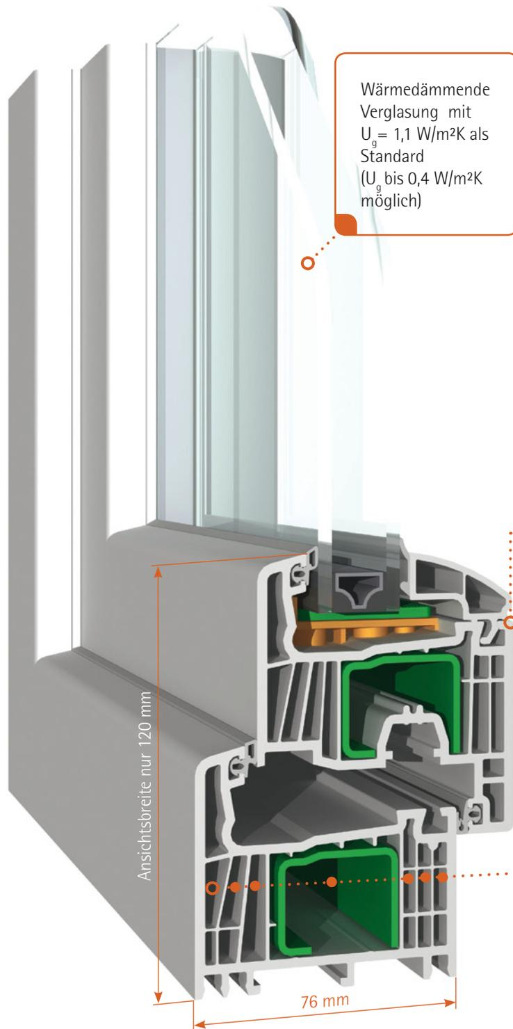
Wärmedämmende Verglasung mit  $U_g = 1,1 \text{ W/m}^2\text{K}$  als Standard ( $U_g$  bis  $0,4 \text{ W/m}^2\text{K}$  möglich)
